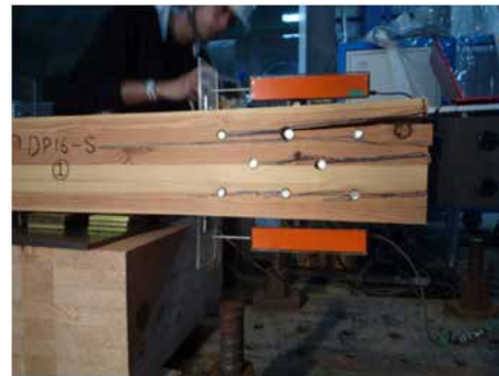
縁寄りのドリフトピン近傍の割裂破壊
