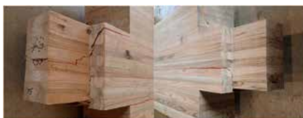
試験終了後の梁端部 No.3
