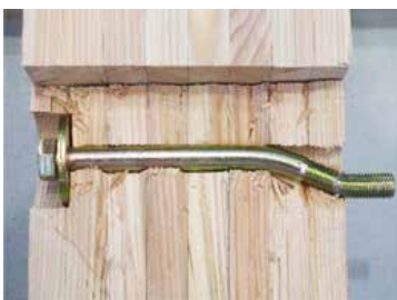
ボルトの曲げ降伏後
