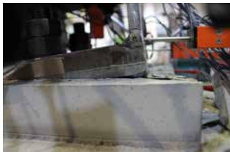
柱脚金物の曲げ変形
