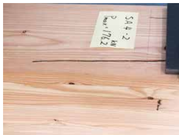
木材の割裂破壊
