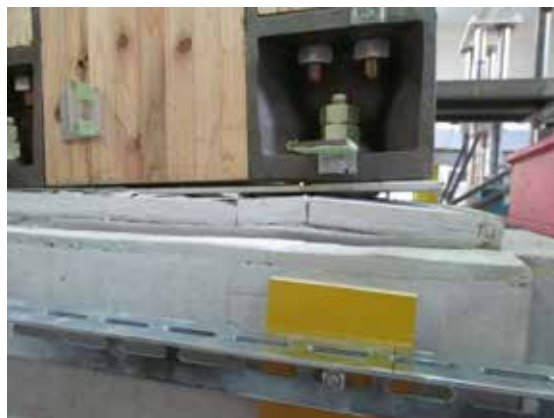
ベースモルタルのひび割れ及びアンカーボルトの伸び
