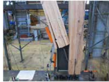
1/50rad 前 正側加力時引張ブレース割裂破壊 1/50rad 前 負側加力時引張ブレース割裂破壊
