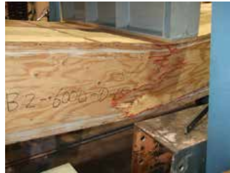
ウェブの曲げ破壊 (試験体 1)
