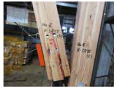
1/75rad 負側加力時引張ブレース割裂破壊
