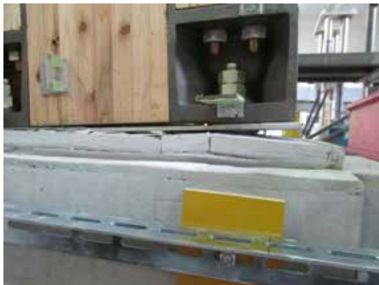
ベースモルタルのひび割れ及びアンカーボルトの伸び
