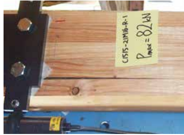
木材の割裂破壊
