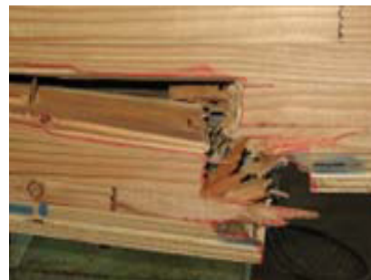
フランジ引張破壊後のウェブの曲げ破壊
