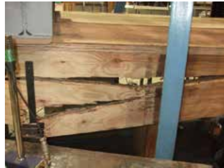
ウェブの曲げ破壊（試験体 2）
