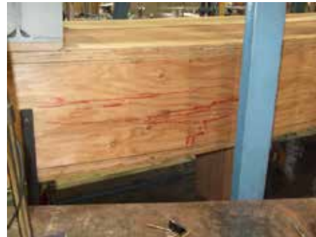
ウェブの曲げ破壊（試験体 1）
