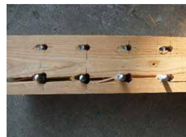
木材の割裂破壊+ボルトの破断
