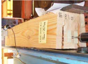
木材の割裂破壊
