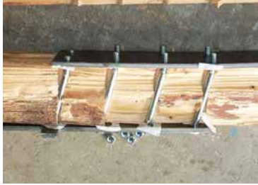
ボルトの曲げ降伏
