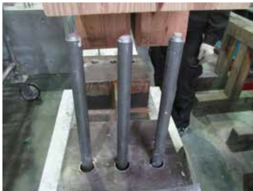
柱脚金物の曲げ変形
