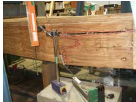
ウェブの曲げ破壊 (試験体3)
