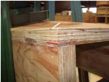
部材間ずれの発生なし (試験体 3)
