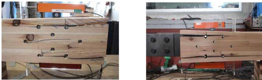
縁側の列に割れが生じ、もう一方の縁側の列に割れが生じた時点で荷重が低下した。中央にある 4 本のドリフトピンの近くにはあまり割れはみられなかった。
