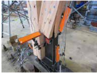
1/75rad 負側加力時ブレース割裂破壊
