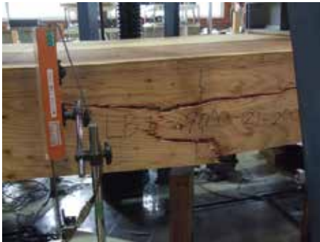
ビスのせん断変形に伴う部材間のずれ（試験体 2）
