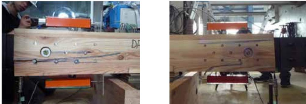
縁寄りのドリフトピン近傍の割裂破壊
