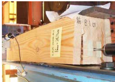
木材の割裂破壊
