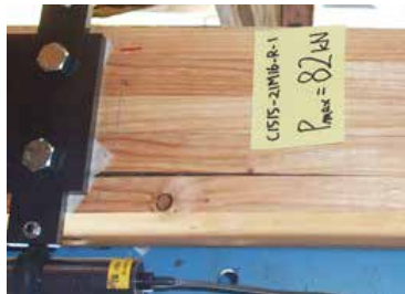
木材の割裂破壊
