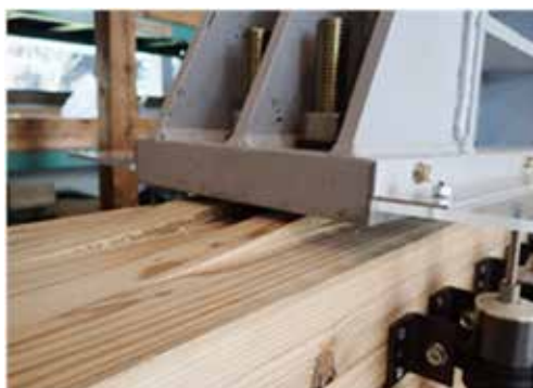
接合具の引抜きに伴う集成材の破壊
