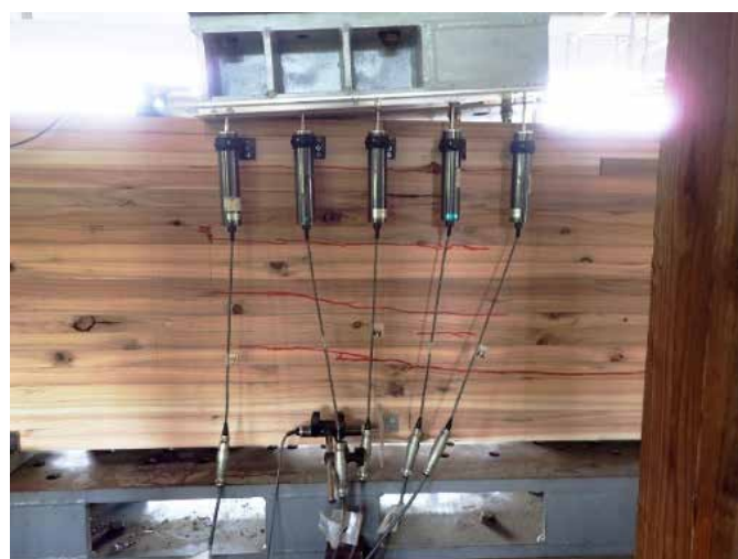
写真 2 部材中央部の割裂破壊
