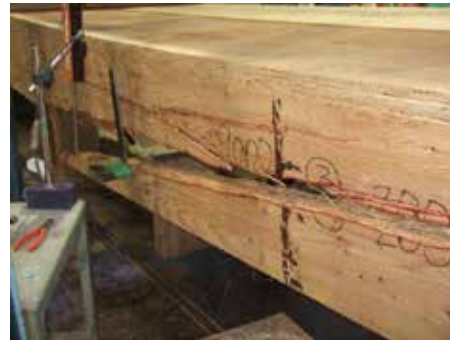
ウェブの曲げ破壊（試験体 3）
