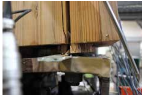
木材の割裂破壊
