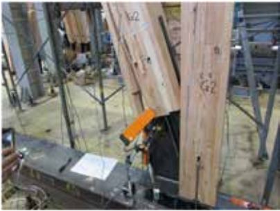
1/75rad 正側加力時 ブレース割裂破壊
