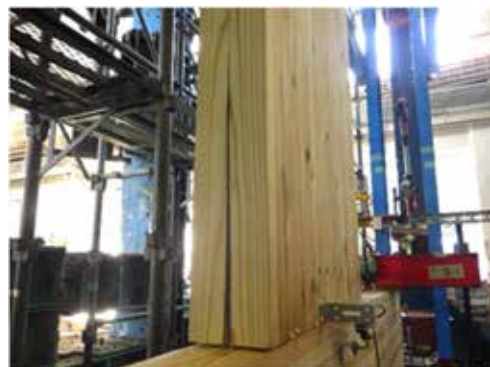
木破及び接合金物周辺の割裂
