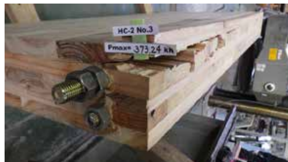
割裂破壊及びコネクタの破断
