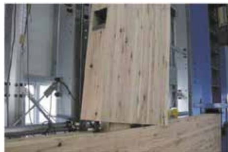
梁木口の柱側面へのめり込み
