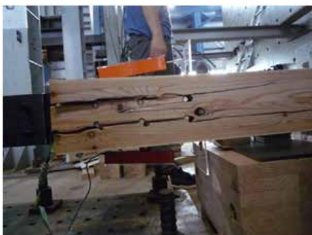
ドリフトピン近傍の割裂破壊
