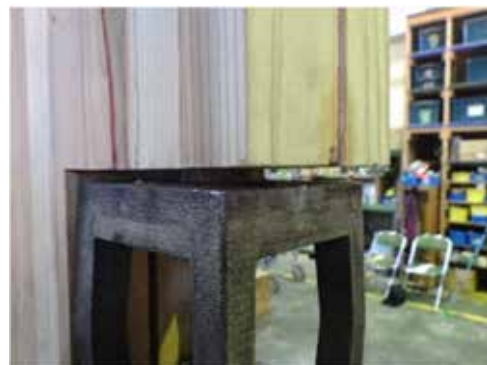
木破及び接合金物周辺の割裂
