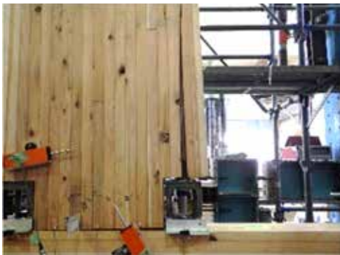
木破及び接合金物周辺の割裂
