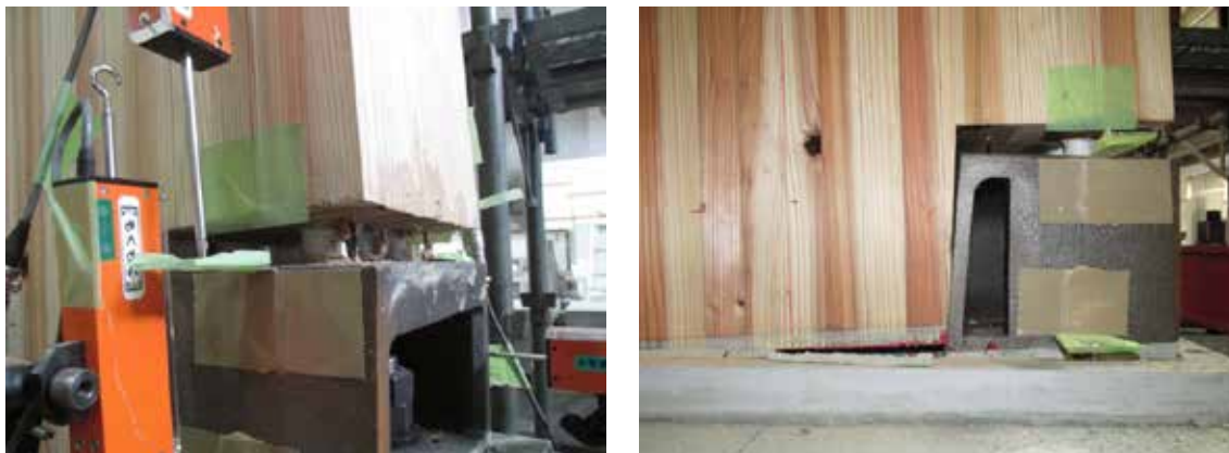
接合金物の破断
