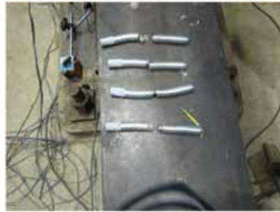
ブレース端部のドリフトピン破断
