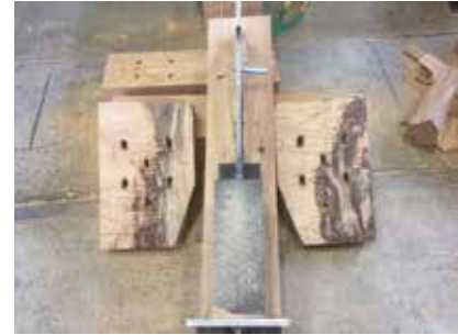
ドリフトピンの破断と二次応力の確認
