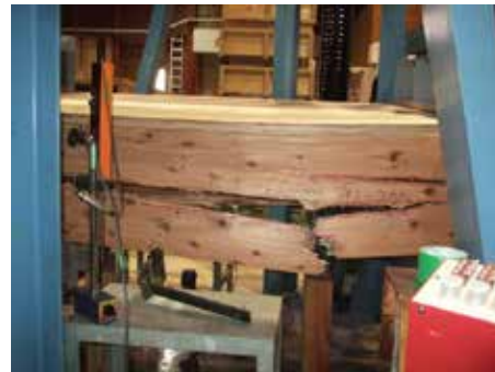
ウェブの曲げ破壊 (試験体 1)
