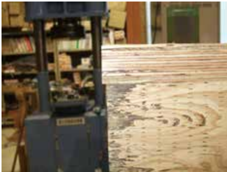
ビスのせん断変形に伴う部材間のずれ (試験体 1)
