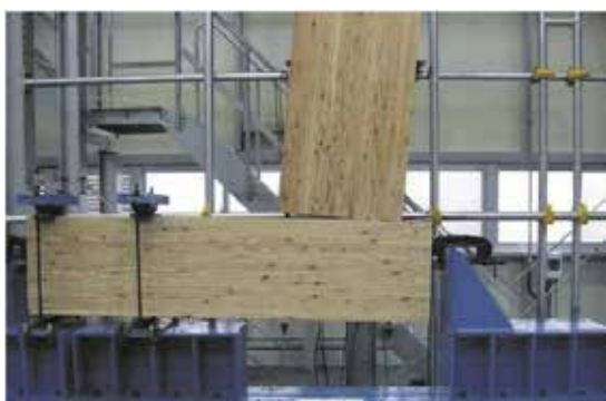
梁木口の柱側面へのめり込み
