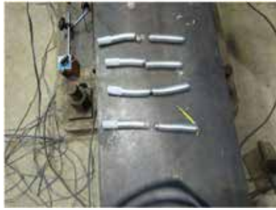
ブレース端部のドリフトピン破断
