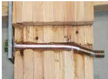
ボルトの曲げ降伏
