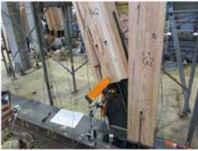
1/75rad 正側加力時 ブレース割裂破壊
