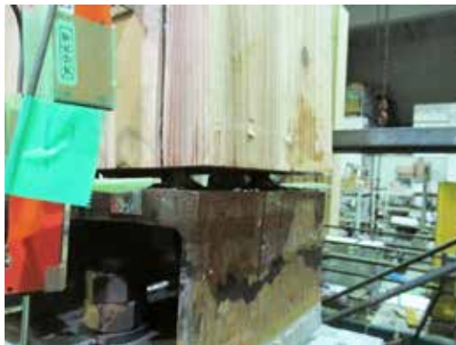
木材の割裂破壊
