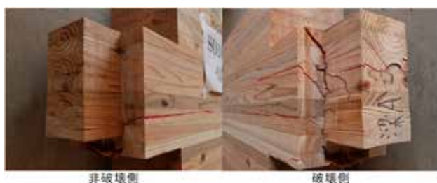
試験終了後の梁端部 No.3
