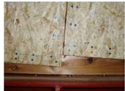
釘接合部のすべり変形（スギ仕様）
