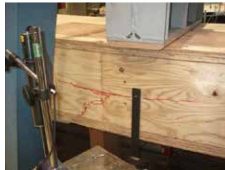
ウェブの曲げ破壊 (試験体 3)
