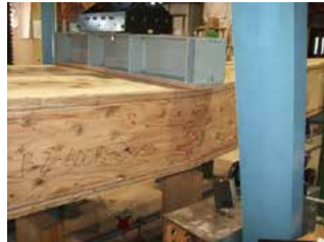
ウェブの曲げ破壊（試験体 2）
