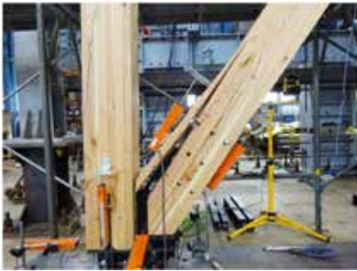
1/50rad ドリフトピンの破断
