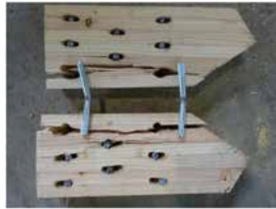
ドリフトピンの破断の様子
