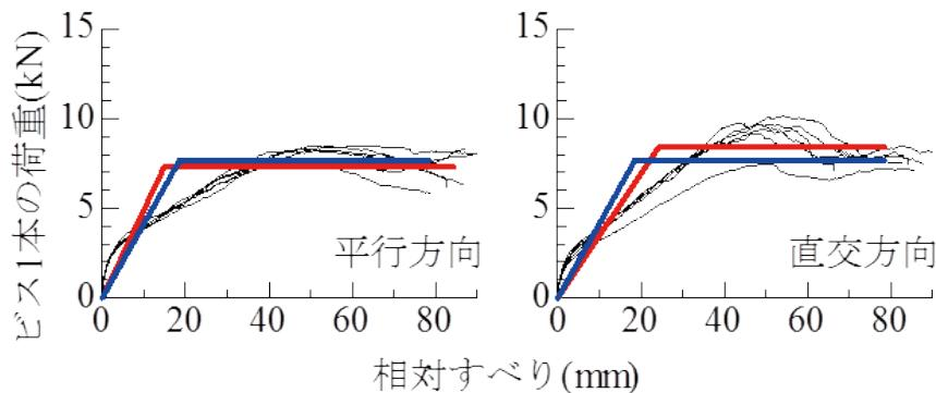
注：赤線は各方向特性値による完全弾塑性モデル、青線は終局耐力、降伏点変位、終局変位を下限値にした場合の完全弾塑性モデル
