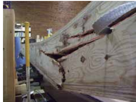
ウェブの曲げ破壊 (試験体 1)
