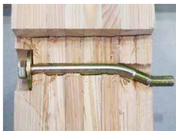
ボルトの曲げ降伏後
